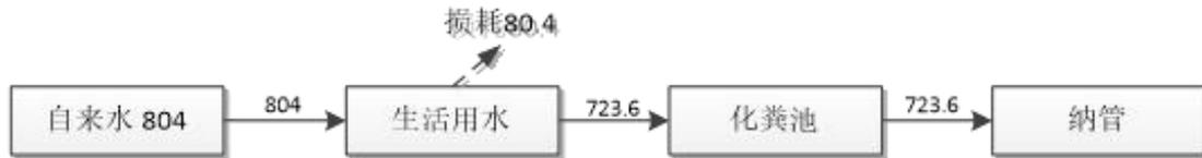
图 3-3 水量平衡图 (单位: t/a)
