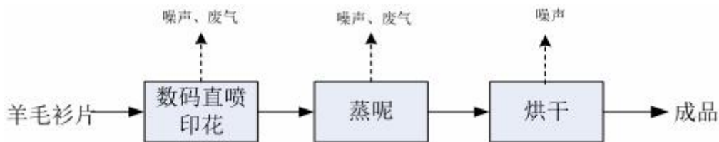
图 3-4 本项目生产工艺及产污环节图
