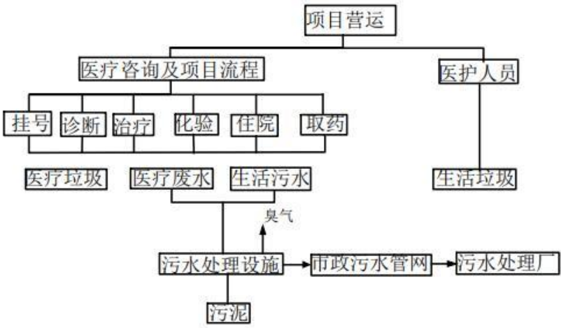
图 3-4 项目营运流程和产污环节图
